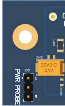
Figure 8. SOM Current Sense Header J301 (5)
