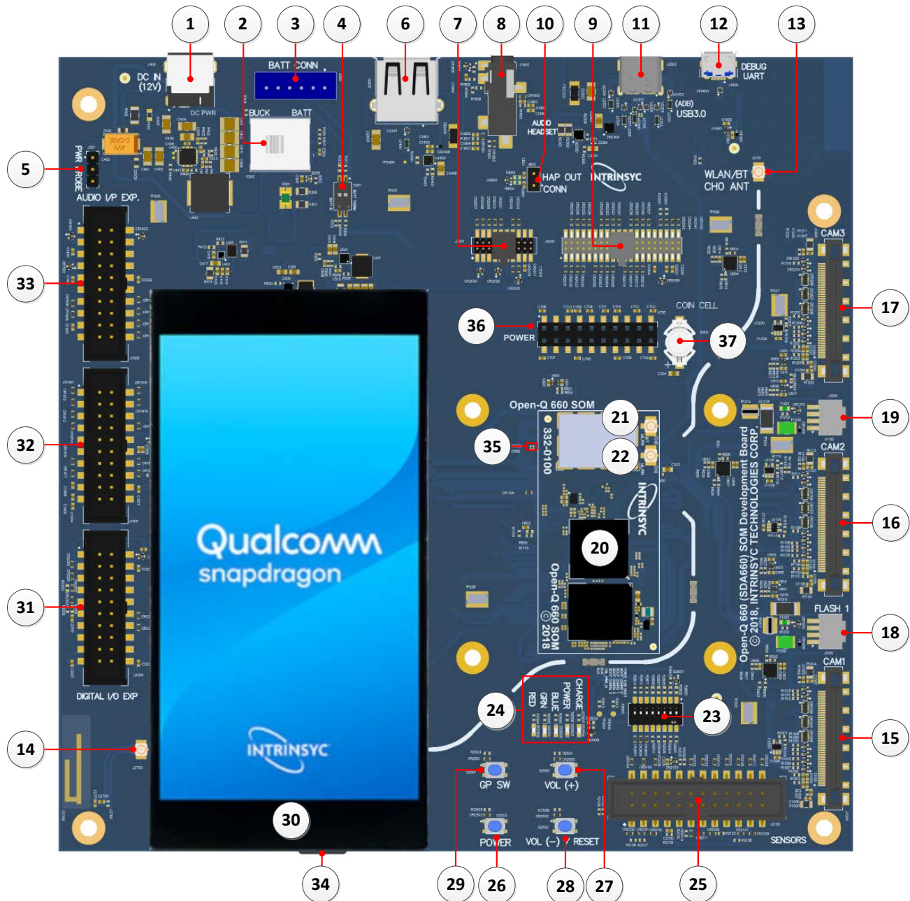
Figure 1. Assembled Open-Q 660 \mu SOM Development Kit
